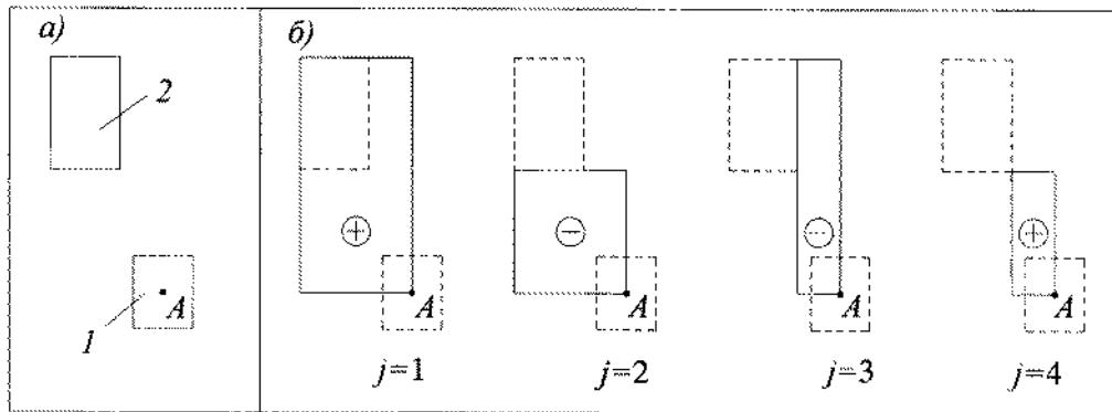
*a* — схема расположения рассчитываемого 1 и влияющего фундамента 2; *б* — схема расположения фиктивных фундаментов с указанием знака напряжений  $\sigma_{zp,j}$  в формуле (5.21) под углом  $j$ -го фундамента
