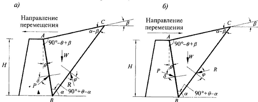
Рисунок 9.2 — Схема к определению величин активного (а), пассивного (б) давления грунта при негоризонтальной поверхности грунта и наклоне граней конструкции к вертикалам
