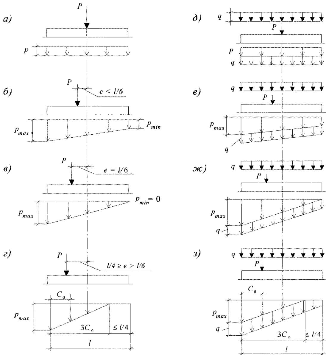
*a—c* — при отсутствии нагрузок на полы; *д—з* — при сплошной равномерно распределенной нагрузке интенсивностью  $q$ ; *а и д* — при центральной нагрузке; *б и е* — при эксцентричности нагрузки  $e < l/6$ ; *в и ж* — при  $e = l/6$ ; *г и з* — при  $e > l/6$  (с частичным отрывом фундамента от грунта)
