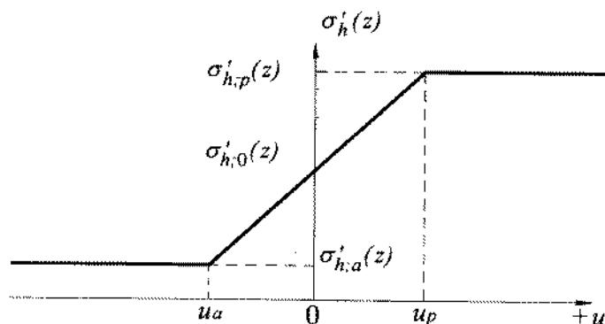
**Рисунок 9.1 — Зависимость величин бокового давления грунта  $\sigma'_h(z)$  от горизонтальных перемещений конструкции  $u$ ,  $u_a=0,001h$ ,  $u_p=(0,01—0,02)h$**
