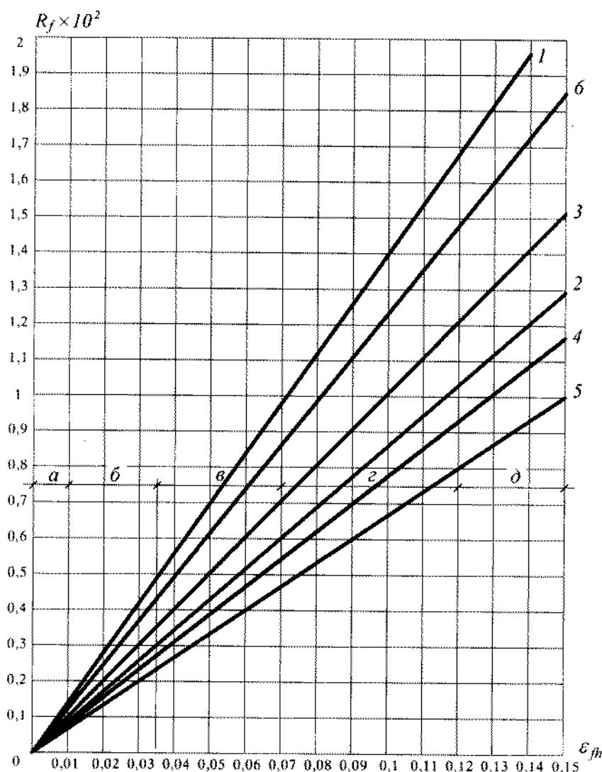
1, 2 — супеси; 3 — суглинки; 4 — суглинки с  $0,07 < I_p \leq 0,13$ ; 5 — суглинки с  $0,13 < I_p \leq 0,17$ ; 6 — глины (в грунтах 2, 4 и 5 содержание пылеватых частиц размером 0,05—0,005 мм составляет более 50 % по массе); *a* — практически непучинистый; *б* — слабопучинистый; *в* — среднепучинистый; *г* — сильноупучинистый; *д* — чрезмернопучинистый
